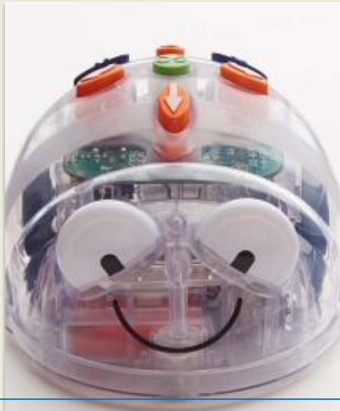
Blue-bot (possibilità di programmare con app per tablet)
